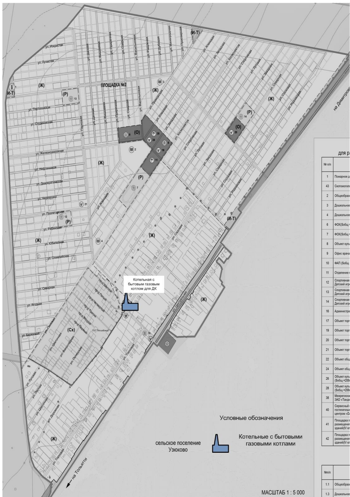
Рисунок 10— Источники тепловой энергии п. Рассвет
