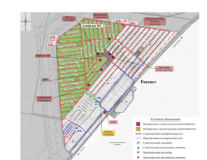
Рисунки 2.4.9.3 - План развития централизованной системы водоснабжения посёлка Рассвет
